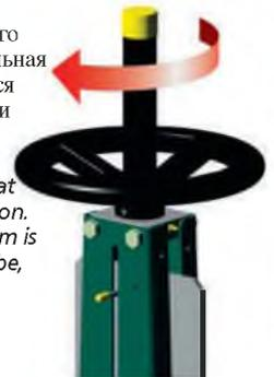
В случае длительного хранения или редкого использования задвижки, регулярно смазывайте шток задвижки.
