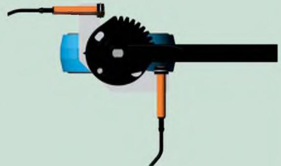
Простое устройство, позволяющее дистанционно контролировать работу затвора.
