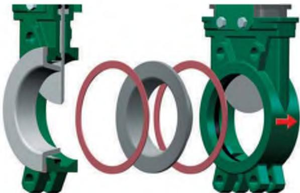
Дефлектор должен быть установлен против движения рабочей среды с прокладками с каждой стороны дефлектора.
